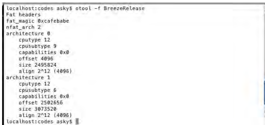
图 1.3 otool 显示同一文件中包含两种架构代码
